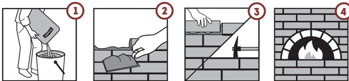
1. Использовать чистую воду, емкости и инструменты. Смесь высыпать в воду в пропорции на 1 кг 0,23-0,26 л воды (на 1 мешок 20 кг 4,6-5,2 л воды) при постоянном перемешивании. Через полчаса перемешать повторно. При повышении вязкости или высыхании раствора – добавить воды и повторно перемешать.
