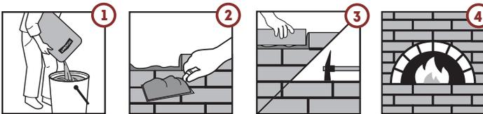
1. Использовать чистую воду, емкости и инструменты. Смесь высыпать в воду в пропорции на 1 кг 0,20-0,25 л воды (на 1 мешок 25 кг 5-6,25 л воды) при постоянном перемешивании. Дать раствору настояться. Через полчаса перемешать повторно. При повышении вязкости или высыхании раствора – добавить воды и повторно перемешать.
